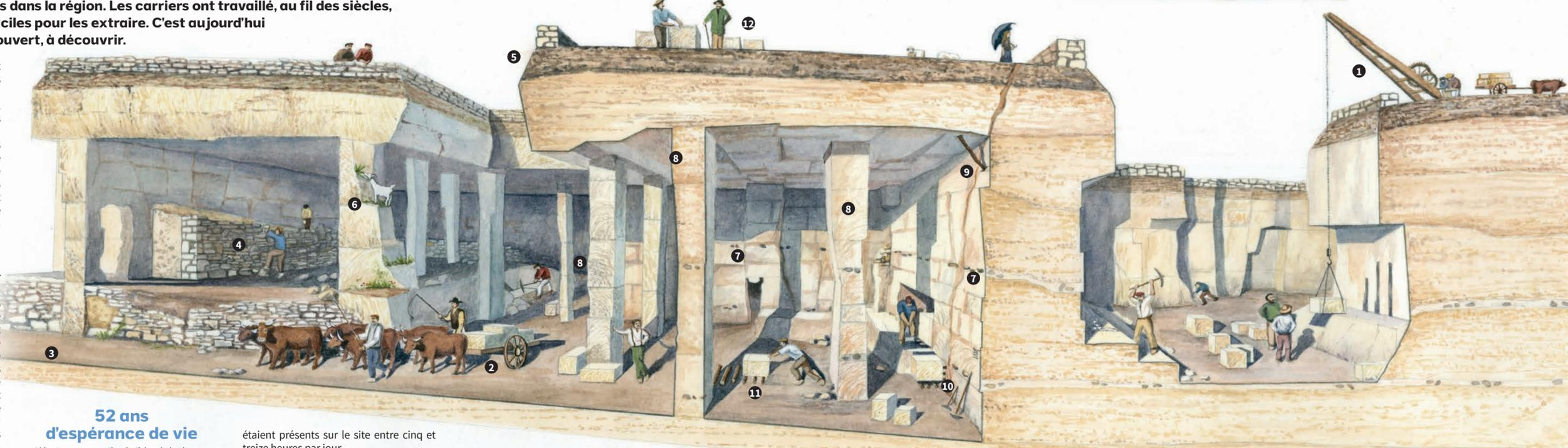
Dessin ci-dessus : Coupe-typique sur les carrières au plus fort de l'exploitation. À partir du milieu du XIX<sup>e</sup> siècle, une grue est utilisée pour sortir les blocs des carrières 1. Auparavant les blocs de pierre sont transportés par des charrettes tirées par 6 bœufs 2 sur une rampe construite en pente douce 3. Lors du creusement de la rampe, les déchets récupérés servent à construire des murs de pierre sèche 4, derrière lesquels
